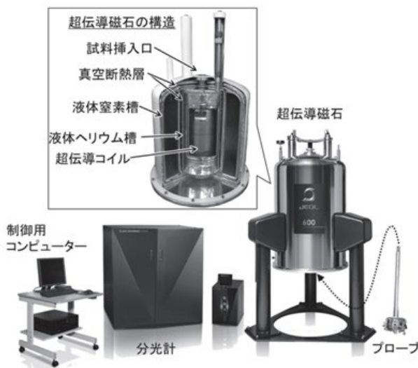
図1 一般的なNMR装置の構成と磁石の構造 3)
