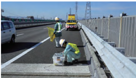
高速道路上での振動測定
